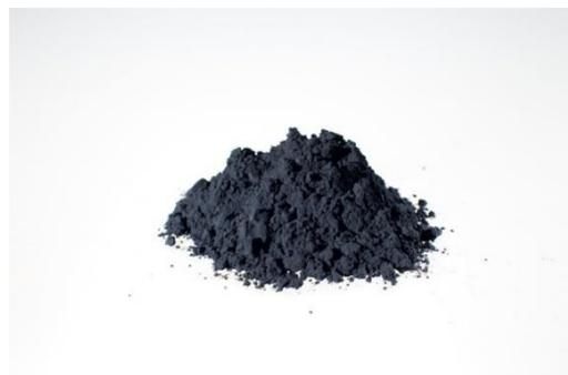
(右) 主に電気自動車の電池材料(正極材)で使用されるニッケル酸リチウム(NCA)
